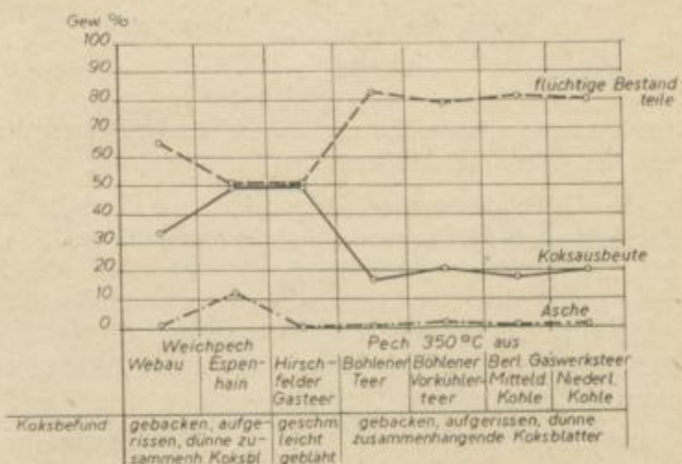
Bild 2. Bindemittel aus Braunkohlenprodukten (Verkokungsergebnisse)
