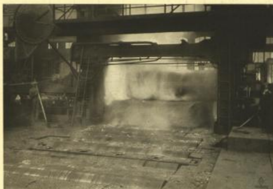
Walzen eines 75 t Blockes.
