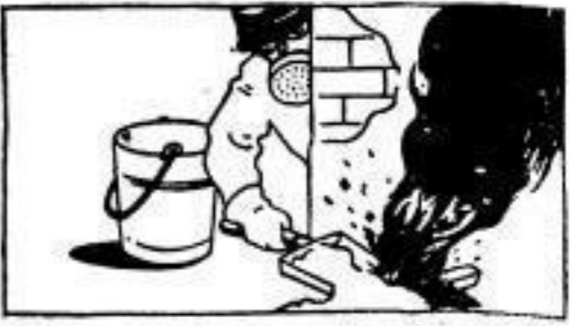
5. Stabbrandbomben grundsätzlich aus sicherer Deckung bekämpfen. In der Nähe der Deckung liegende Brandbomben mit Sand abdecken.
