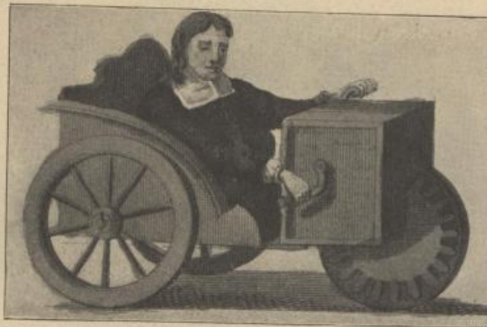
Kunstwagen mit Handantrieb von Stefan Farfler. Altdorf bei Nürnberg. Mitte des XVII. Jahrhunderts.
