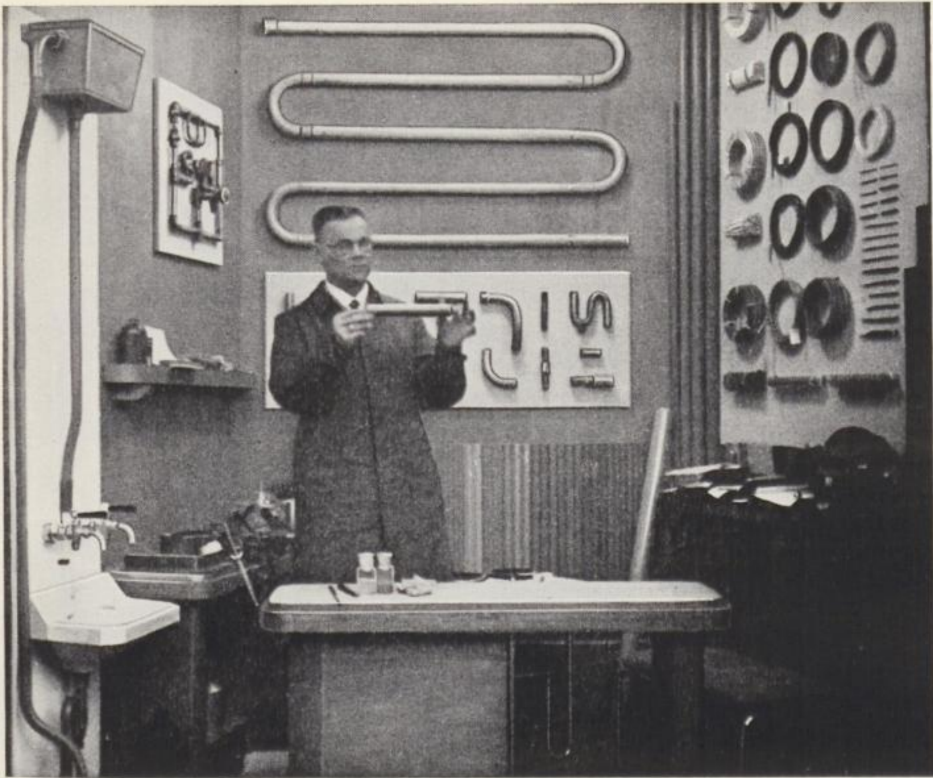
Vorführung von Verbindungsarbeiten an Mipolamrohren in dem Werbepavillon „Der Spritzguß plastischer Massen“ Leipzig 1939
