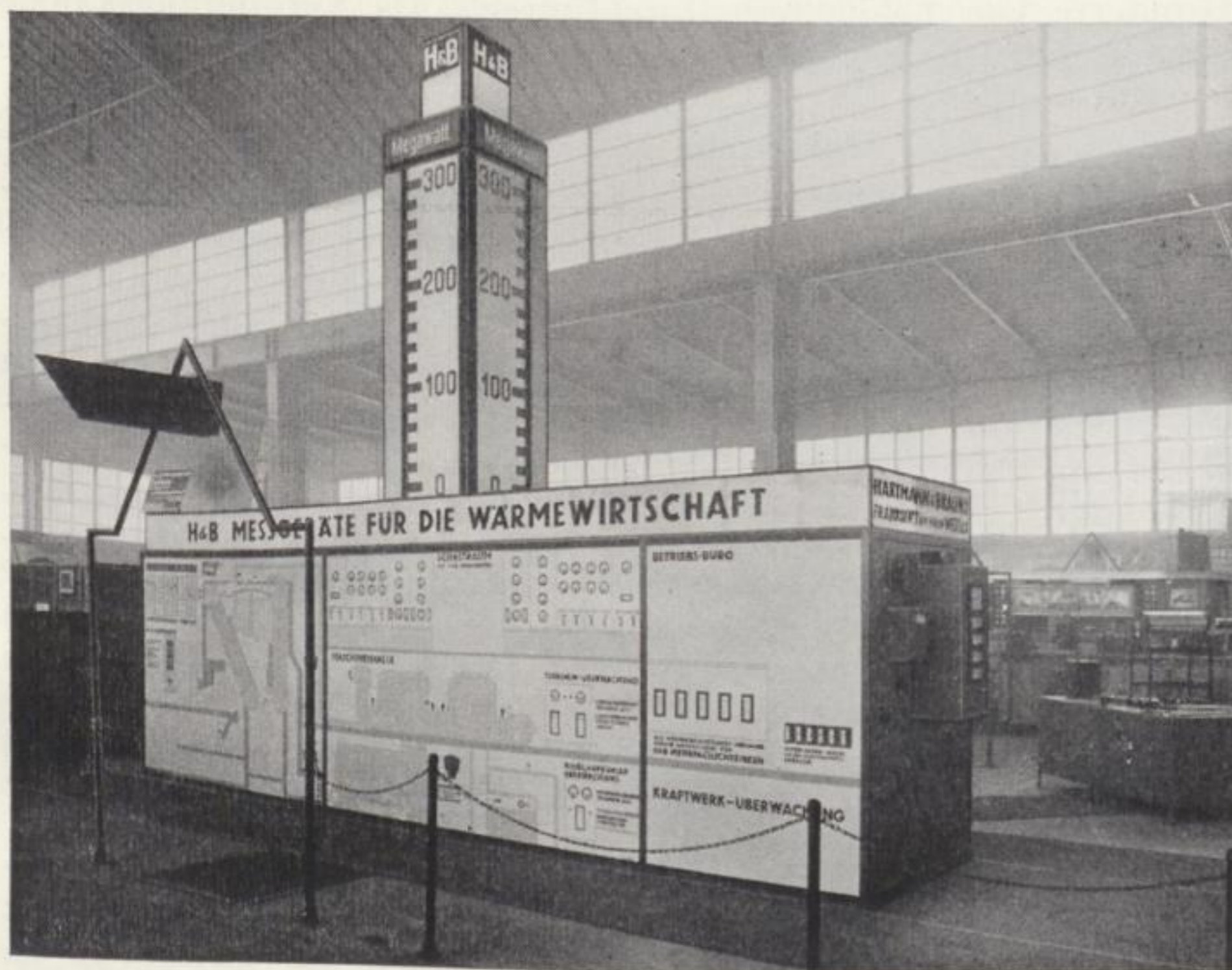
Großanzeigergeräte für Fernübertragung von Meßwerten, vorgeführt in Halle 21 der Großen Technischen Messe und Baumesse Leipzig (HARTMANN & BRAUN AG)
