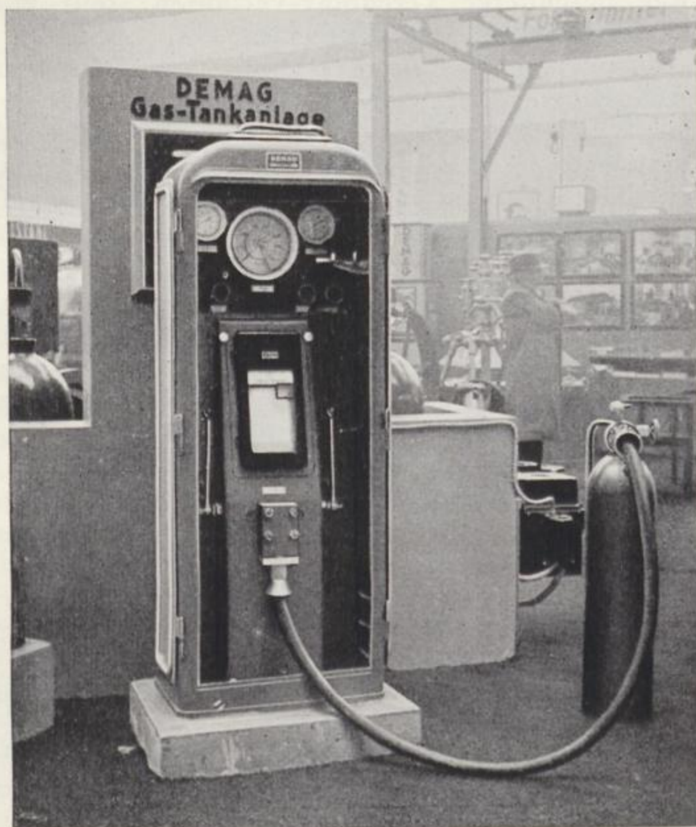
Gastankstelle auf der Technischen Messe Leipzig 1939 (DEMAG)
