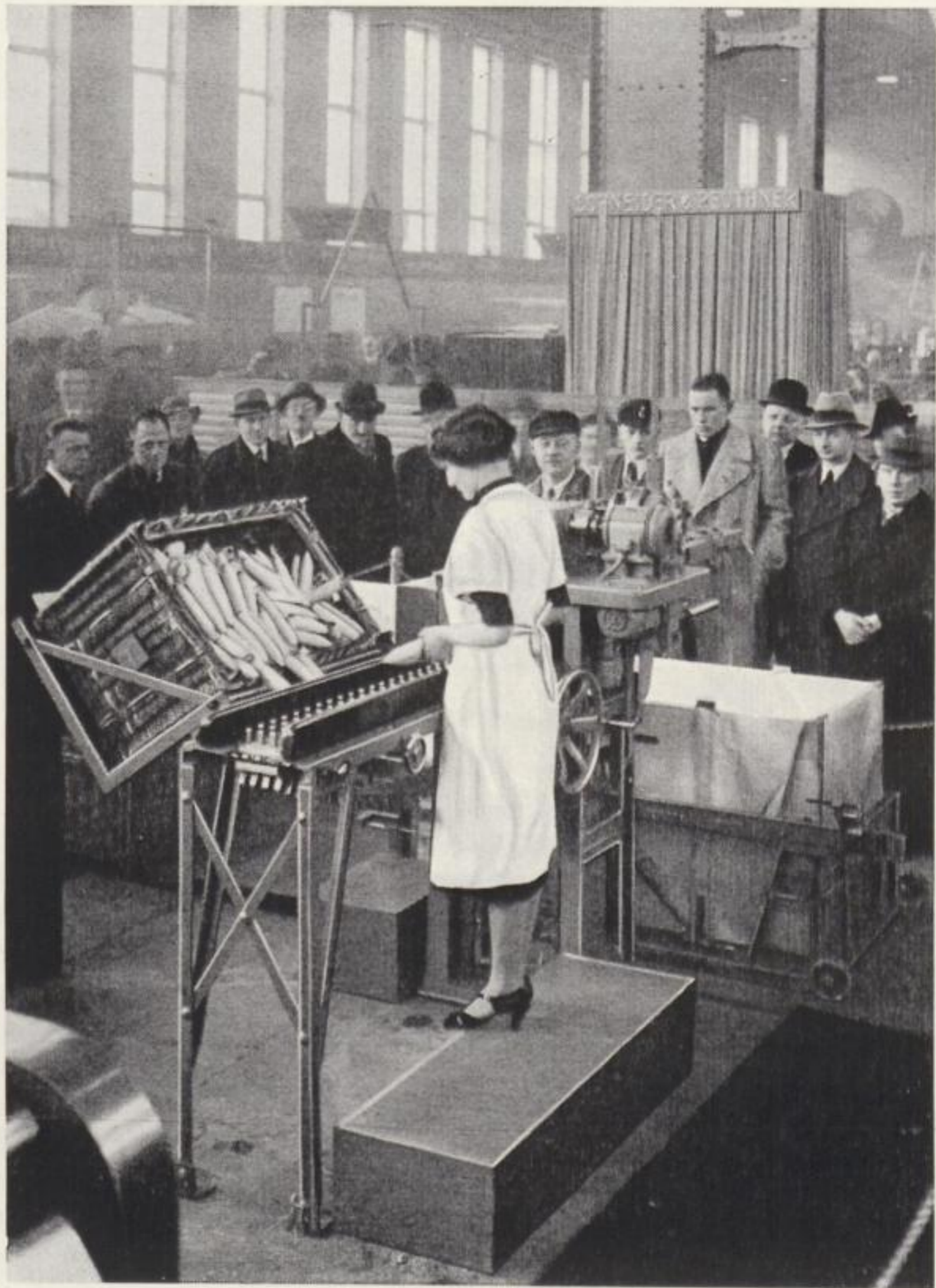
Betriebsmäßige Vorführung einer automatischen Kötzerverpackungs- maschine in der Halle Textilmaschinen der Technischen Messe Leipzig (SÄCHSISCHE TEXTILMASCHINENFABRIK vorm. RICHARD HARTMANN AG)
