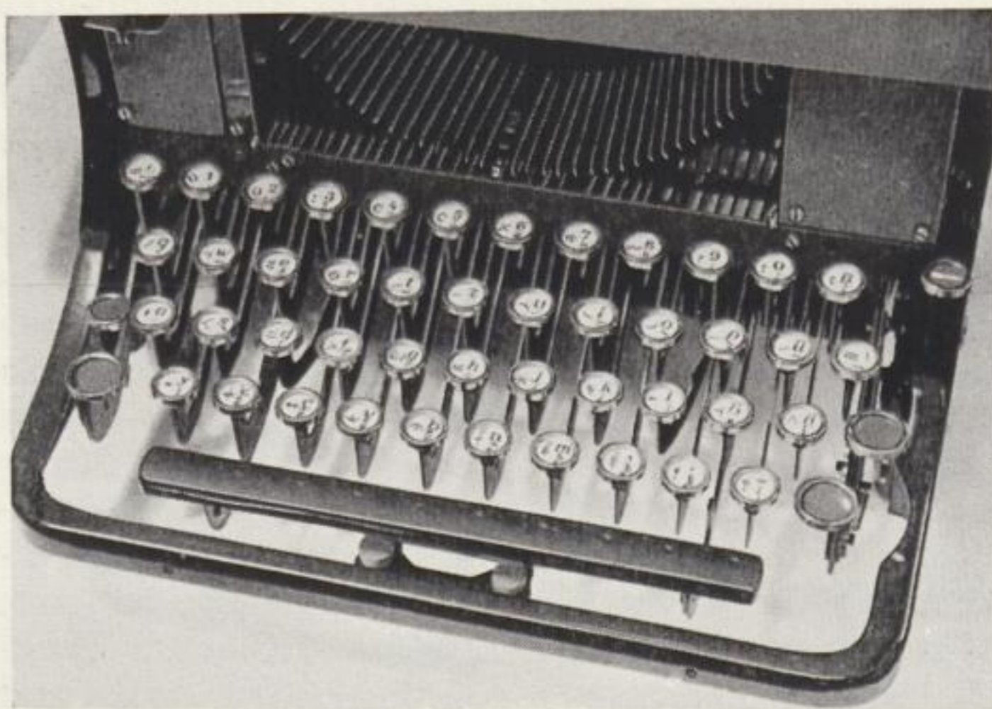
Tastatur einer textschreibenden Notenschreibmaschine, vorgeführt auf der Technischen Messe Leipzig (WANDERER-WERKE AG)
