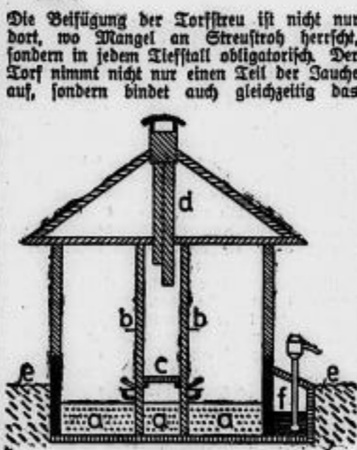
Abbildung 2 Querschnitt durch einen Tiefstall a = abgelagerter Dünger, b = Stützen des Futtertisches, c = Futtertisch, d = Ventilator, e = Erdoberfläche, f = Jauengrube
