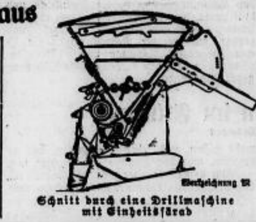
Schnitt durch eine Drillmaschine mit Einheitsstrab
