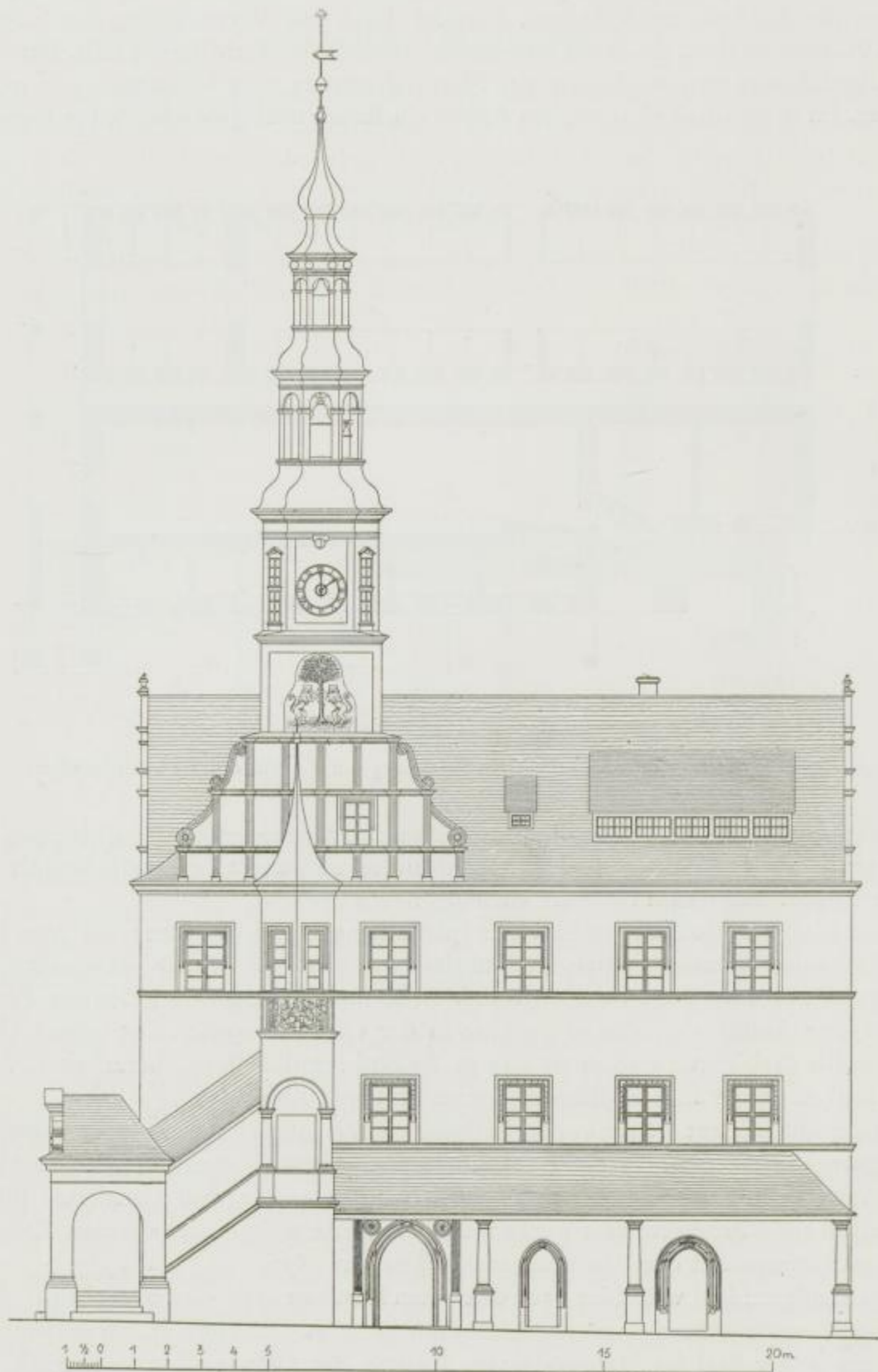
Abb. 147. Ansicht des Rathauses von Osten, Bauzustand im 18. Jahrhundert (Rekonstruktion)
