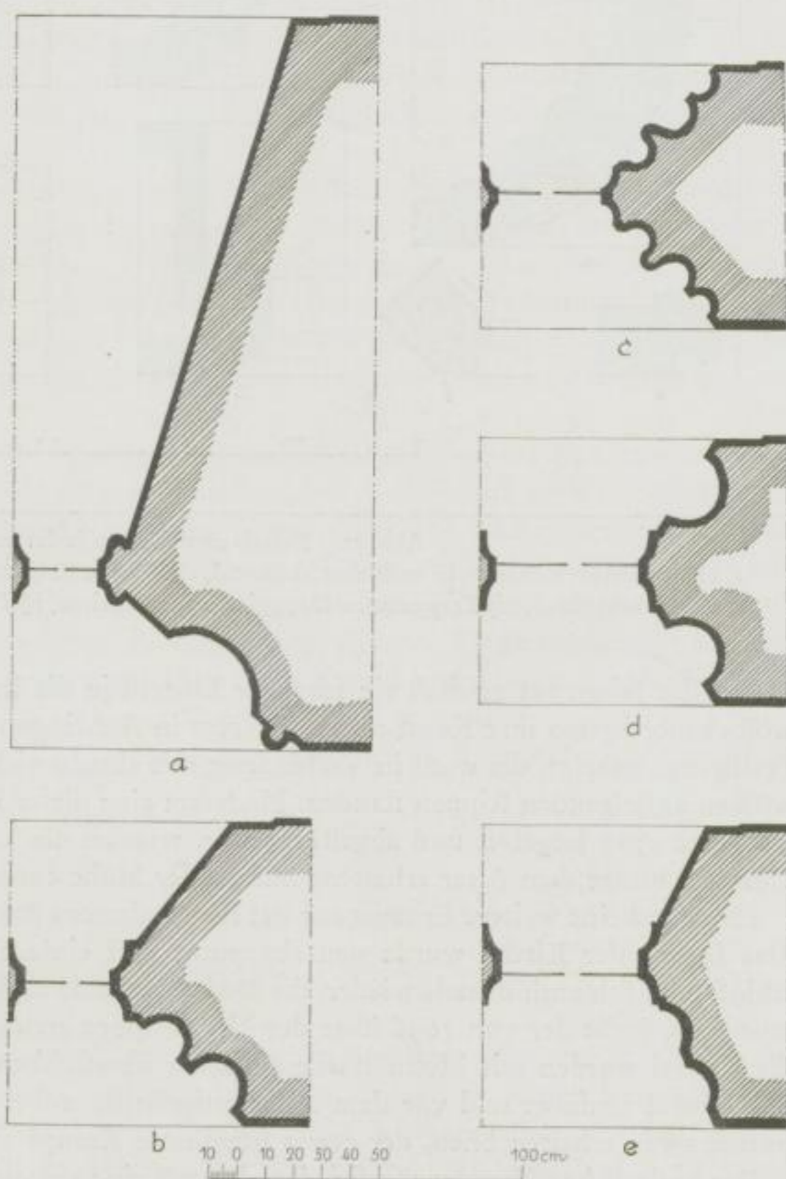
Abb. 50. Fensterprofile der Stadtkirche a) Fenster im Turmerdgeschoß; b) Fenster der Nord- und Südwand und am Chor aus der Zeit bis 1521; c) Sakristeifenster; d) Fenster der Nordwand aus der Zeit um 1540; e) Gedoppeltes Fenster der Nordwand um 1540
