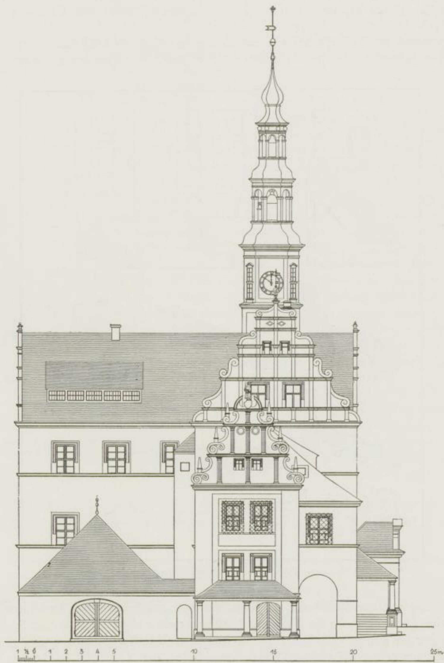
Abb. 148. Ansicht des Rathauses von Westen, Bauzustand um die Mitte des 18. Jahrhunderts (Rekonstruktion)
