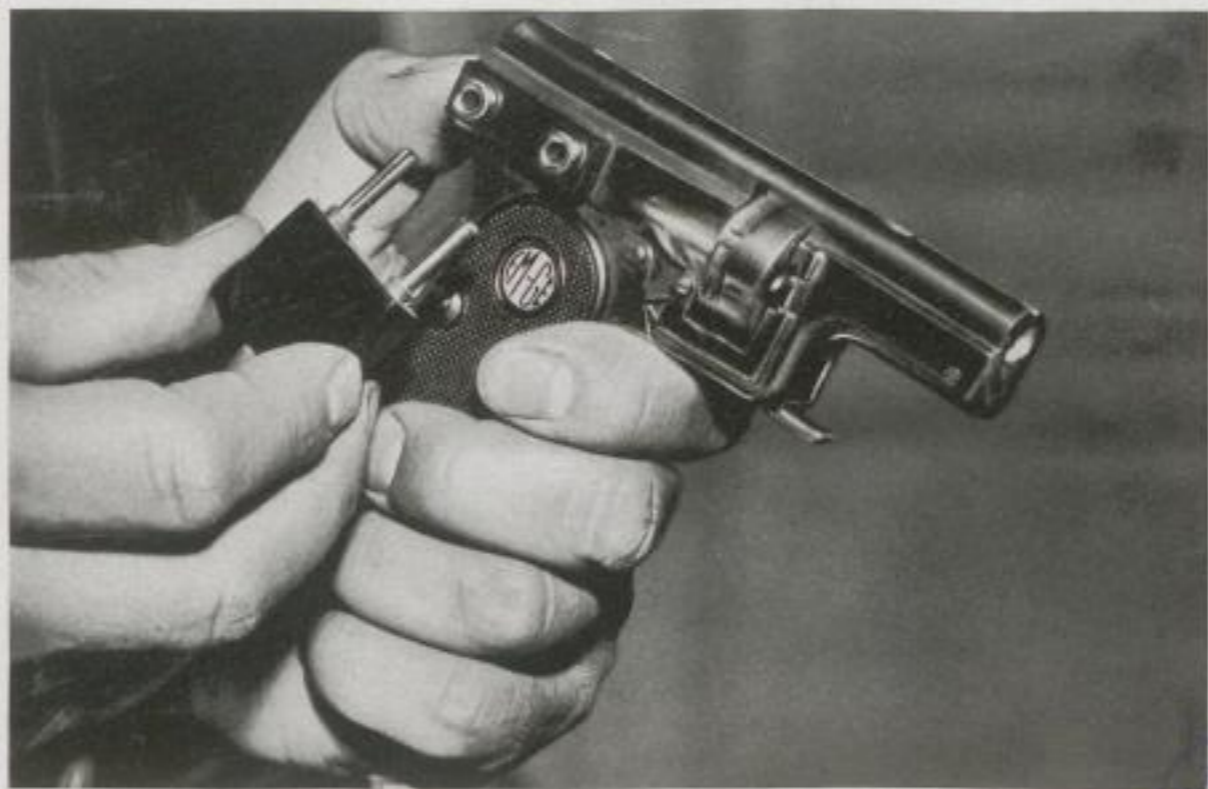
Die Startpistole mit elektrischem Kontakt, wie sie bei den Olympischen Spielen verwendet wird.
