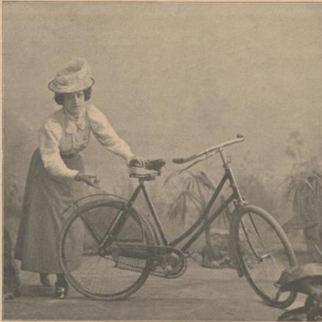
Fig. II. „Genius“-Kleiderschutz mit aufgeklappten Seitenflügeln.
