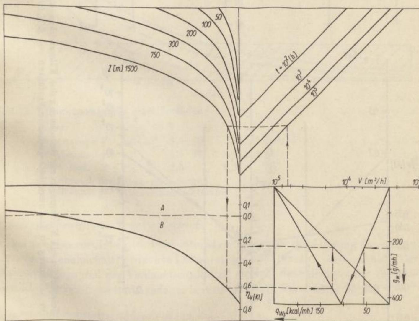
Bild 22a. Beispiel für ein Nomogramm zur Berechnung des Klimawirkungsgrades in Erz- oder Kohlengruben
