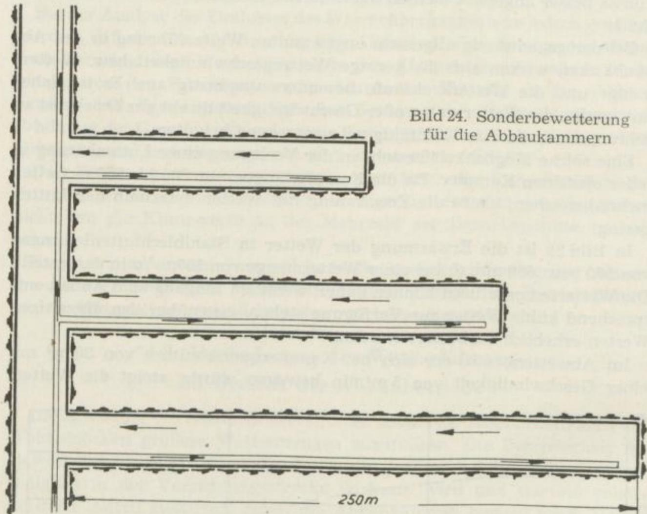
müßte entweder die Sonderbewetterungsanlage für den gesamten Abbau-block entsprechend Bild 24 zusammengefaßt oder eine Abwetterstrecke aufgeföhren werden (Bild 25).
