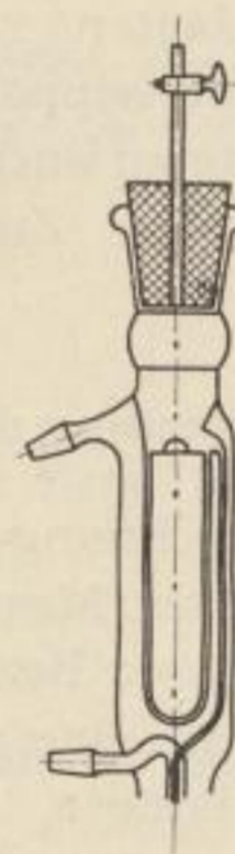
Bild 4. Einsatzgefäß zur Apparatur für Dichtemessung
