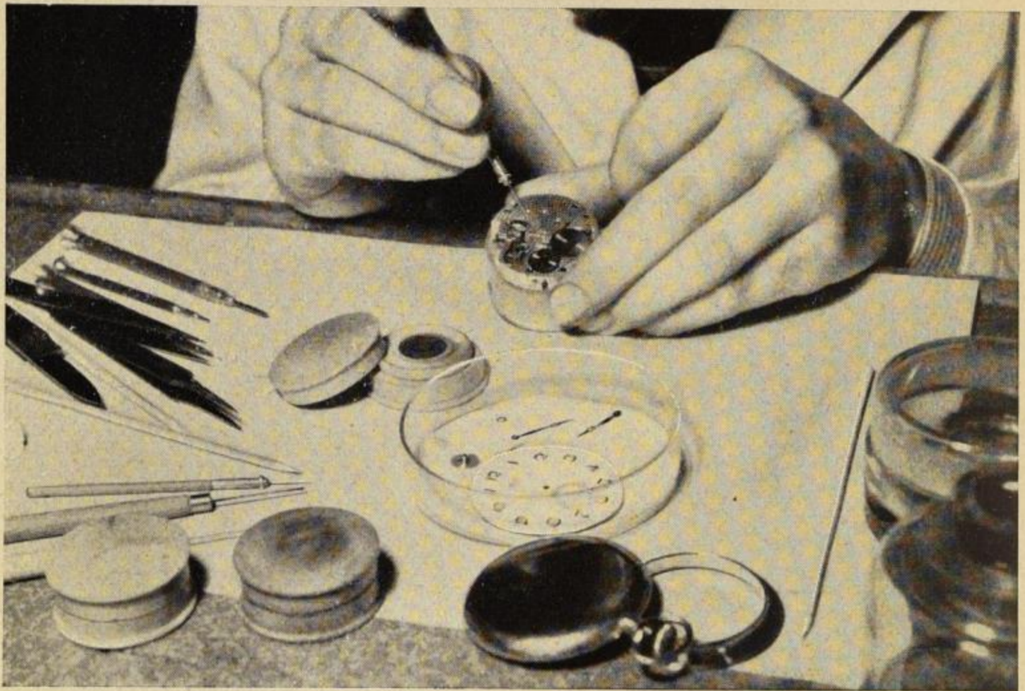
Eine Taschenuhr wird nach beendeter Überholung mit Öl versehen
