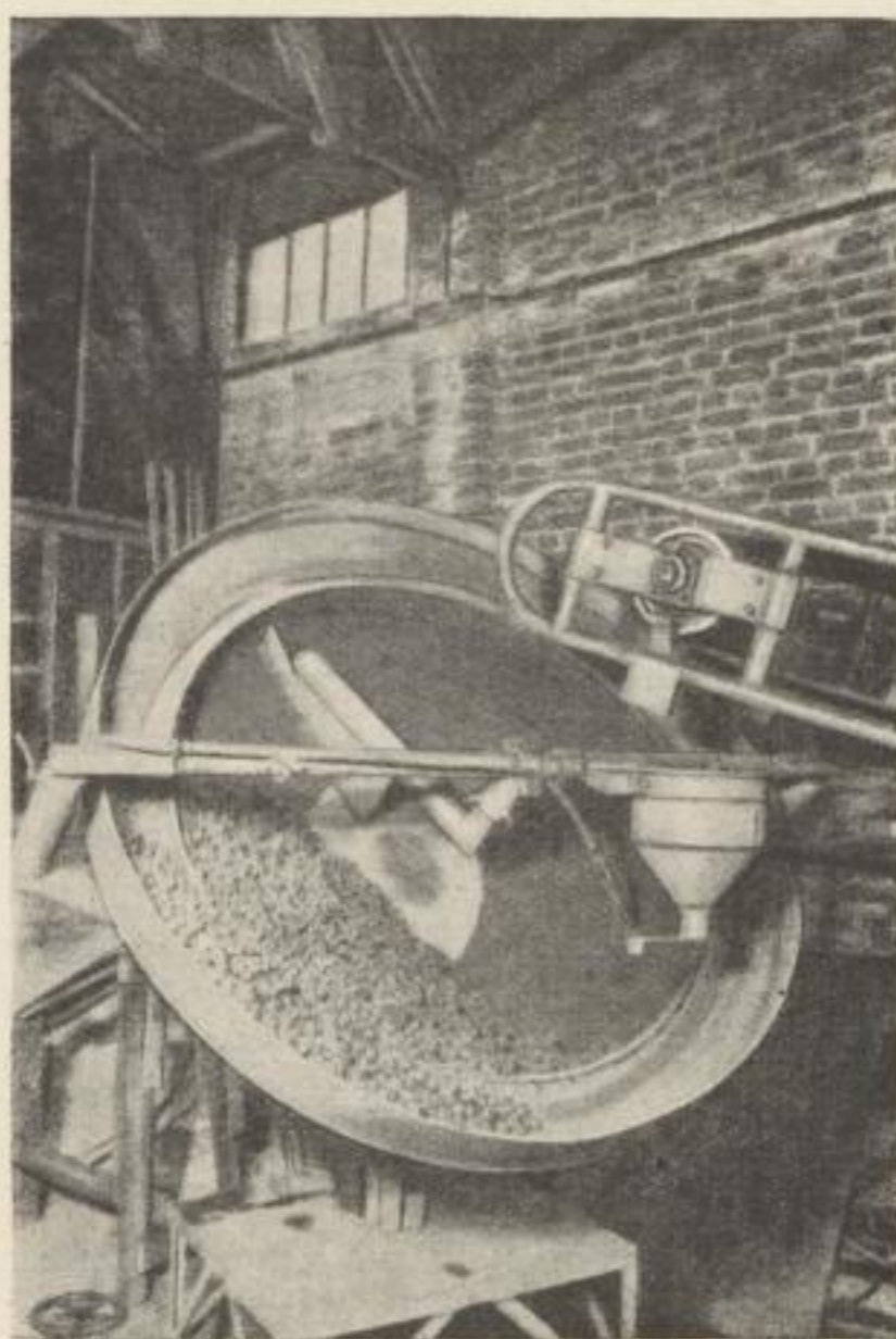
Bild 6. Selbstgebauter Pelletisierteller für die Stückigmachung feinkörniger Erze und anderer Eisenträger
