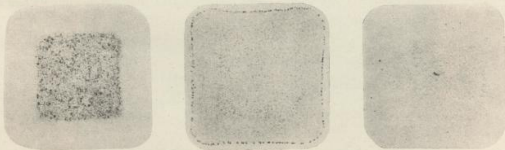
Bild 4. Baumannabdrucke von Knüppelquerschnitten aus unberuhigtem, kernberuhigtem und beruhigtem Stahl
