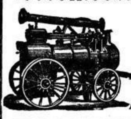
Eine 16-pferdig Hochdruck-Expansion-Locomobile auf Locomotiv-Kessel, gebaut 1889.
