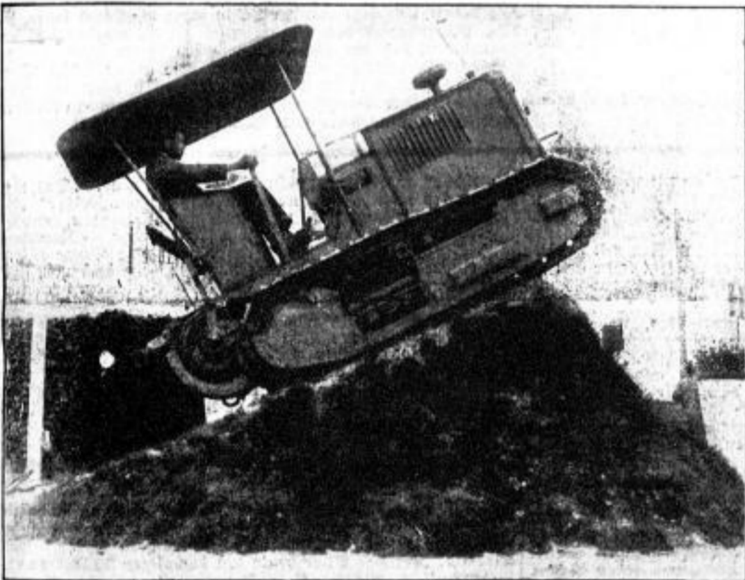
Von der 34. Wanderausstellung der Deutschen Landwirtschafts-Gesellschaft in Leipzig. Ein Raupenschlepper beim Erstimmen einer steilen Anhöhe. Dieses Fahrzeug ist in der Lage, Steigungen bis zu 45 Grad zu bewältigen.
