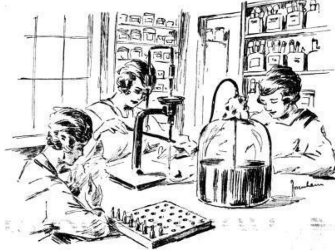
Die mit Serum gefüllten Ampullen werden zugeschmolzen
