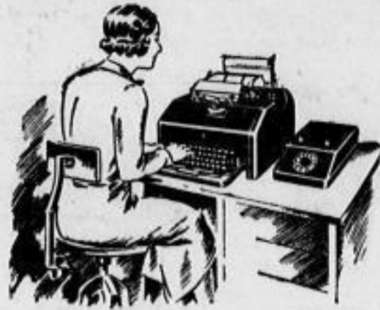
Siemens-Fernschreiber. Das rechts neben dem Fernschreiber stehende Zusatzgerät dient zum Herstellen der Verbindung mit dem fernem Teilnehmer.
