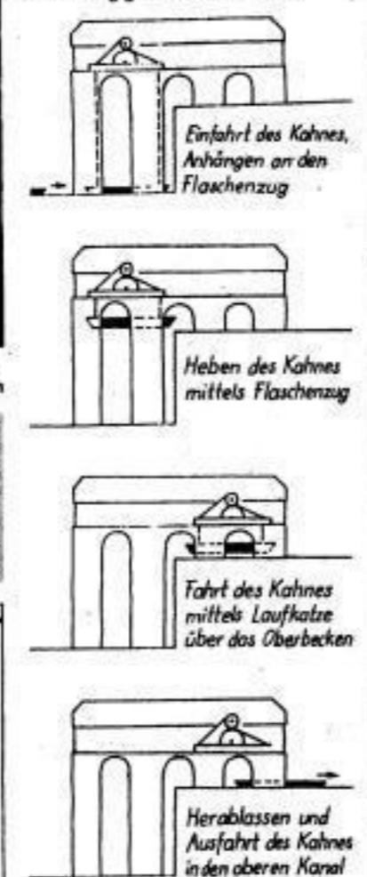
Funktionskizzen des Schiffshebewerks Rothenfurth bei Freiberg, 1788/90
