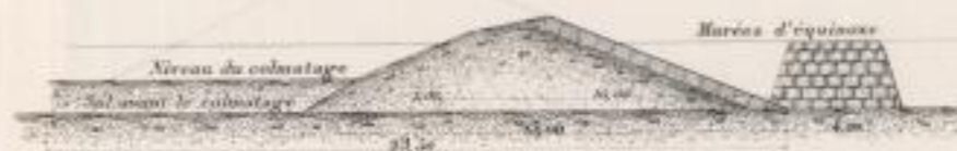
Fig. 3. Terrassement des digues définitives (1 re période).
