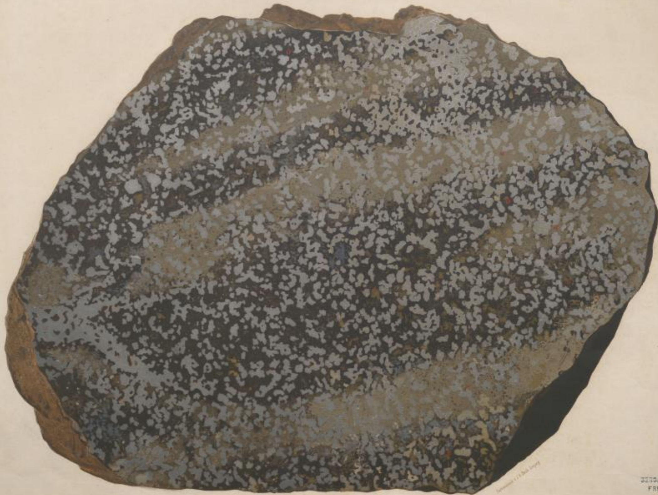
Hauptschnitt an Eisen-Meteorit von Rittersgrün. (Natürliche Grösse) Die rechte Hälfte ist nach der Fälschung geätzt.
