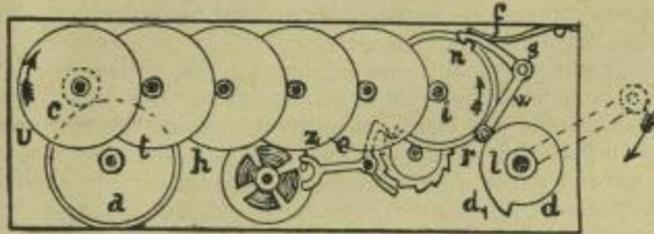
folge die Klinke s auslöst, wodurch der Zahn n für einen Augenblick frei wird, welcher aber genügt, um ihn passieren zu lassen, sodaß die Scheibe i eine Umdrehung vollführen kann.
