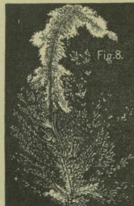
Fig. 8. Entladungsschlag nach Planté.
