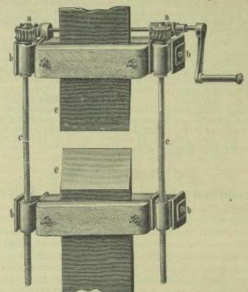
Näh-, Binde- und Schlagriemen), Pumpenklappen, Büffel- und Walroäleder, Lederbandagen, Lederkitt, Nitschelhosen, Riemenverbindungen. Besonders hervorzuheben ist der von der Firma hergestellte gesetzlich geschätzte Riemenspanner mit Schneckengetriebe, (siehe Abbildung mit Beschreibung). Die Herstellung der Riemen geschieht in kürzester Frist; die Lokalitätsverhältnisse und maschinellen Einrichtungen setzen den Produktionsfähigkeiten der Firma keine Grenzen.
