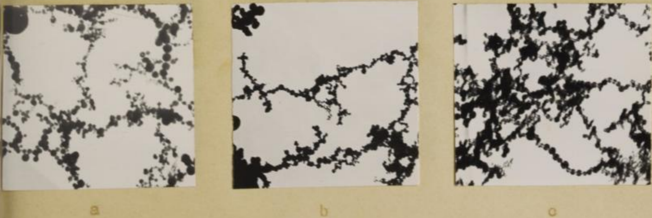
Abb. 30 a zeigt reines Lichtbogenoxid b zeigt Lichtbogenoxid mit 0,57 Gew.-% Lithium c zeigt Lichtbogenoxid mit 11,91 Gew.-% Magnesium
