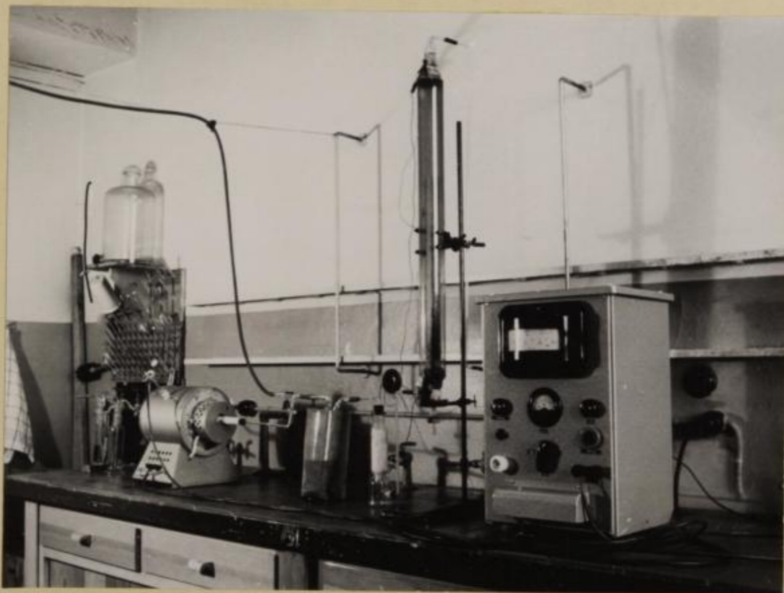
Abb. 1 Apparatur zum Sintern der Elektroden
