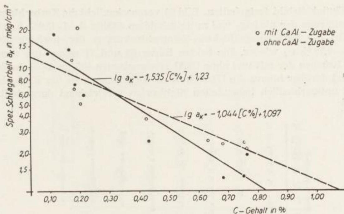
Bild 68. Kerbschlagzähigkeitswerte verschieden behandelte Stähle bei unterschiedlichem C-Gehalt quer zur Walzrichtung. (Die Punkte geben den Mittelwert von drei Proben an, Proben geschlagen bei 20° C)
