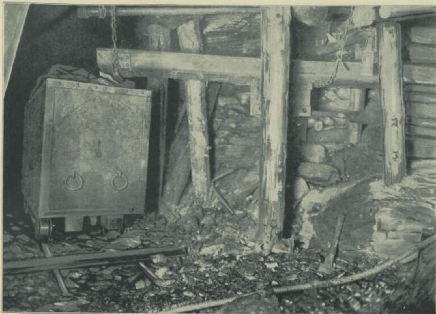
Abbau im Grundflöz mit Schüttelrutchen-Betrieb
