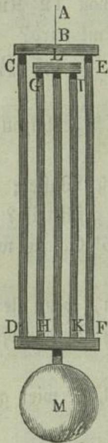
Wenn nun bei der Temperatur  $t^{\circ}$  die Länge  $AM$  des Pendels  $= L$ , der Ausdehnungs-Coefficient des Eisens aber  $= a$  und der des Metalls der inneren Stangen  $= a_1$  ist, wie groß muß die Länge  $x$  der inneren Stangen genommen werden, damit der Einfluß der Wärme auf die Länge des Pendels compensirt werde?
