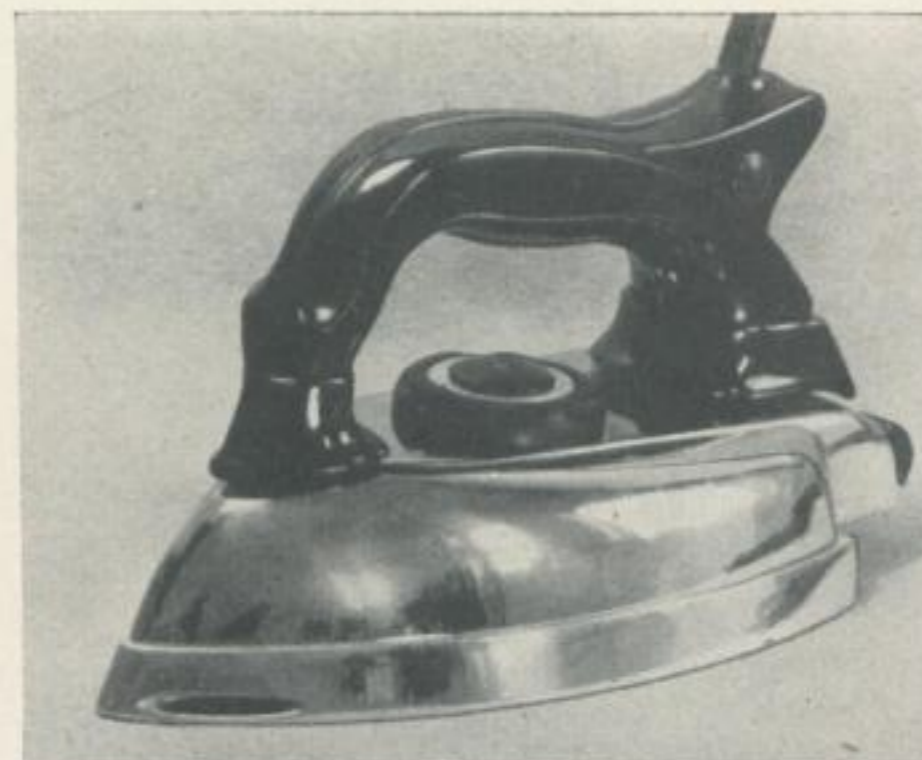
Reglerbügeleisen, Entwurf VEB EWS ab 1956 bis jetzt Ausführung wie EWS 1951, jedoch ohne Griffschalter. Dafür auf Haubenmitte Drehknopf, der auf gewünschte Bügeltemperatur (je nach Wäscheart von etwa 100° bis etwa 250° C) eingestellt werden kann. Knopf aus Kunststoff mit Farbe wie Griff. Sohle aus Aluminium.
