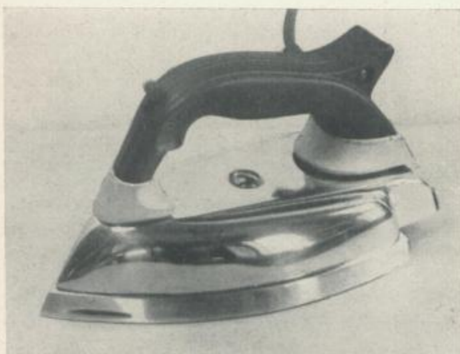
Schalterbügeleisen, Entwurf VEB EWS 1948/49 Griff aus Preßstoff (dunkelbraun) mit Schalter, festem, seitlichem Schnuranschluß und Signallampe, die im eingeschalteten Zustand leuchtet, und angesetzten Porzellanzwischenstücken zur Wärmedämmung. Rückwärtiger Griffansatz und am hinteren Haubenende aufgesetzte Porzellannocken bilden stabile Dreipunktaufgabe zur Abstellung des Eisens. (Haube und Sohle wie „Siemens“ 1930–1945)
