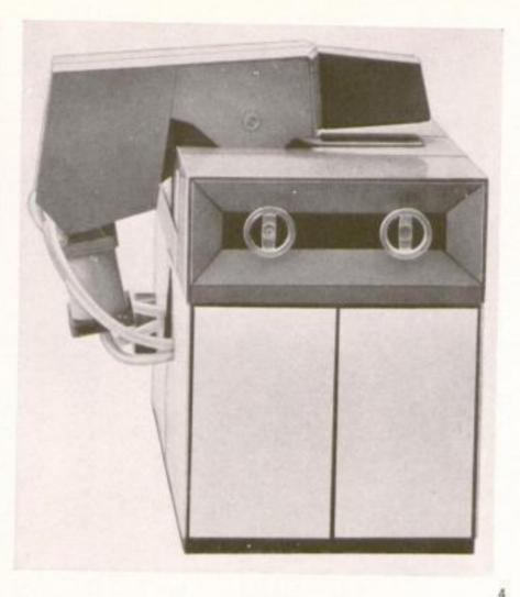
2 3 4 Felgen-Abbrennstumpfschweißmaschine SF 12,5
