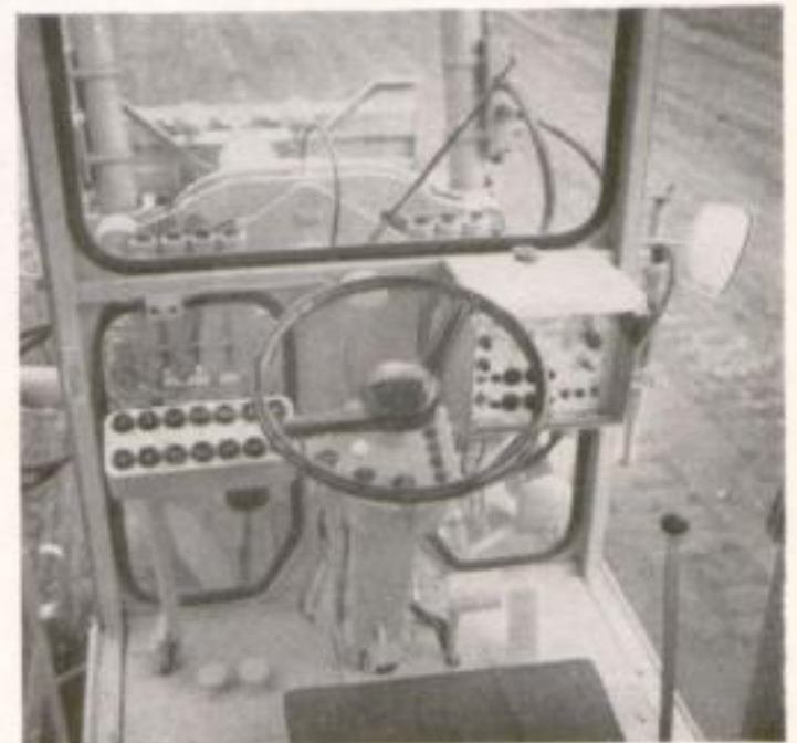
15 Lenksäule senkrecht stehend: Stellung für Feinplanierungs-, Böschungs-, Heckaufreißerarbeiten u. a.
