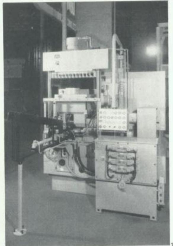
Einständer-Exzenterpressen PEE II 250 gestalterisch bestimmt, die in ihrer konstruktiv-gestalterischen Konzeption einheitlich erscheinen. Zugänglichkeit und Wartung für den Operateur der automatischen Fertigungslinie BK 211 sind optimal gestaltet. Der gesamte Funktionsablauf wird durch eine zentrale Steuerung kontrolliert.
