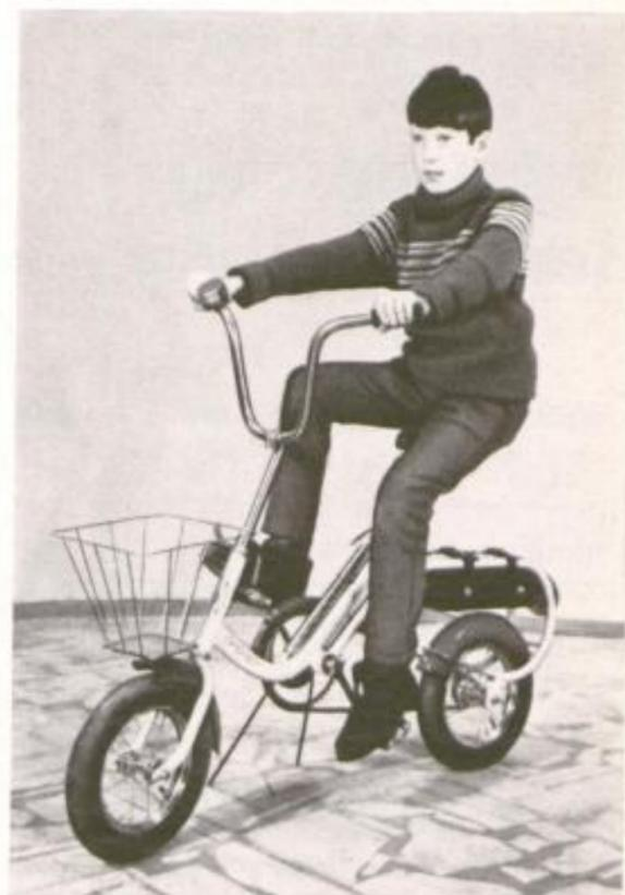
Das Fahrrad STRELA mit dem niedrigen Sattel ist für sportliche Zwecke gedacht. Wenn sich der Fahrer beim Treten der Pedalen an der Rückenlehne des Sitzes abstützt, ist eine schnelle Erhöhung des Drehmomentes der Pedalen zu erreichen.
