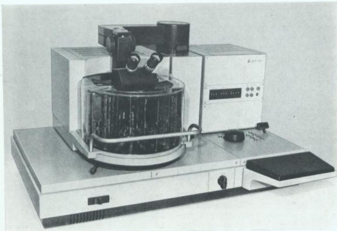
eine Piacrylabdeckung die völlige Einsicht in die fächerförmig angeordneten Leiterplatten der Pin-Elektronik ermöglicht. Das Gefäß der Steuerelektronik, auf der rechten Seite oberhalb der Aluminiumgußwanne angebracht, fügt sich in Form und Größe den verwendeten EGS-Baugruppen ein; das entspricht dem Streben nach einer ganzheitlichen Gestalterscheinung im Sinne des Zusammenhangs von Form- und Figureigenheiten.
