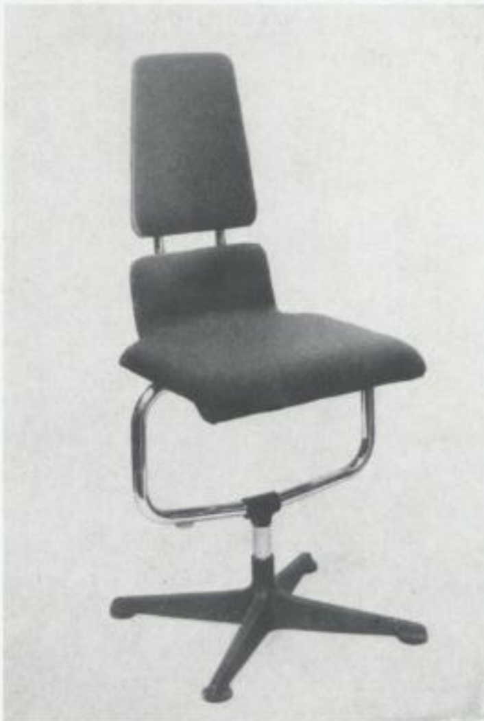
2/3 Variante I, Stuhl auf vier Füßen: Anpassung der Sitzhöhe über Verstellhülsen aus Polyamid; Gewindebolzen, die sich innen befinden, übertragen die Kraft, Kerben im Metallfuß dienen zur Orientierung beim Einstellen der Höhe. Die Rückenlehne, eingehängt in einen Stahlrohrbügel, kann beliebig in der Höhe verstellt werden. Beckenstütze und Rückenlehne bestehen aus einem Stück.
