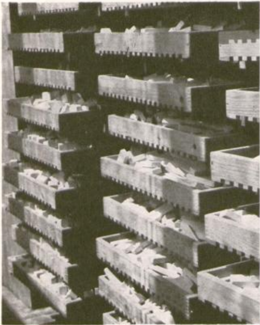
4 Zwischenlagern: für ein- bzw. mehrtägiges Nach- trocknen der aufgehellten Holzteile
