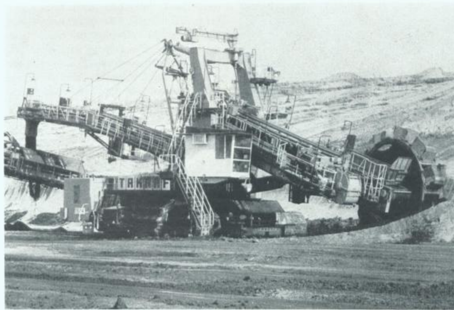
5 Das im Verbund mit dem Schaufelradträger schwenkbare Maschinenhaus. Die Gestaltung konzentrierte sich auf die mit Sicken versehenen Abdeckungen des Gehäuses.
