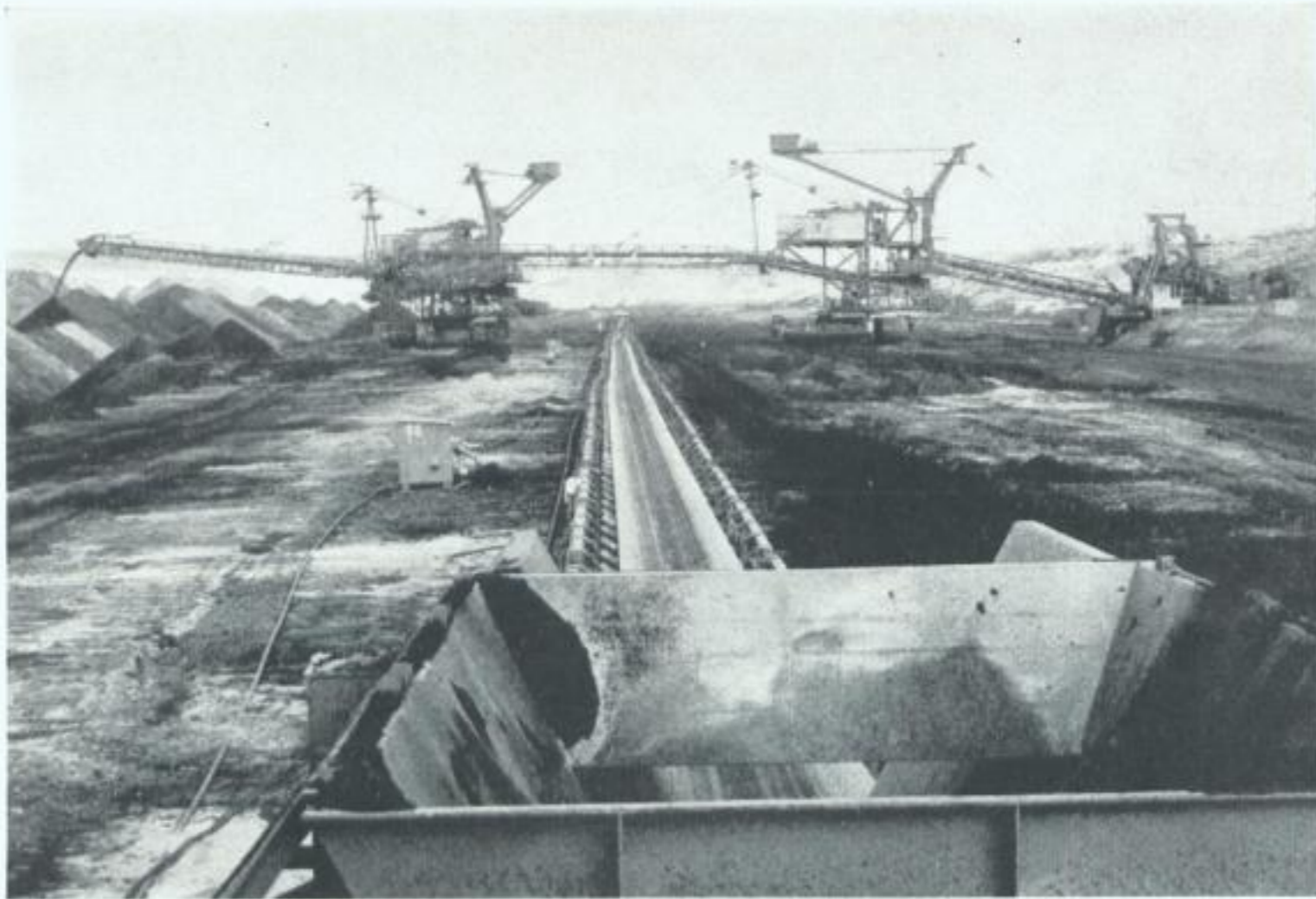
1 Vorgängertyp der Baggerklasse O aus dem Jahre 1953, Typ SRs 315 Hersteller: VEB Lauchhammerwerk Eigenmasse: 350 t deutlich der Unterschied im Erscheinungsbild – vom rein konstruktives Gebilde des SRs 315 zur modernen Kompaktbauweise des SRs 320
