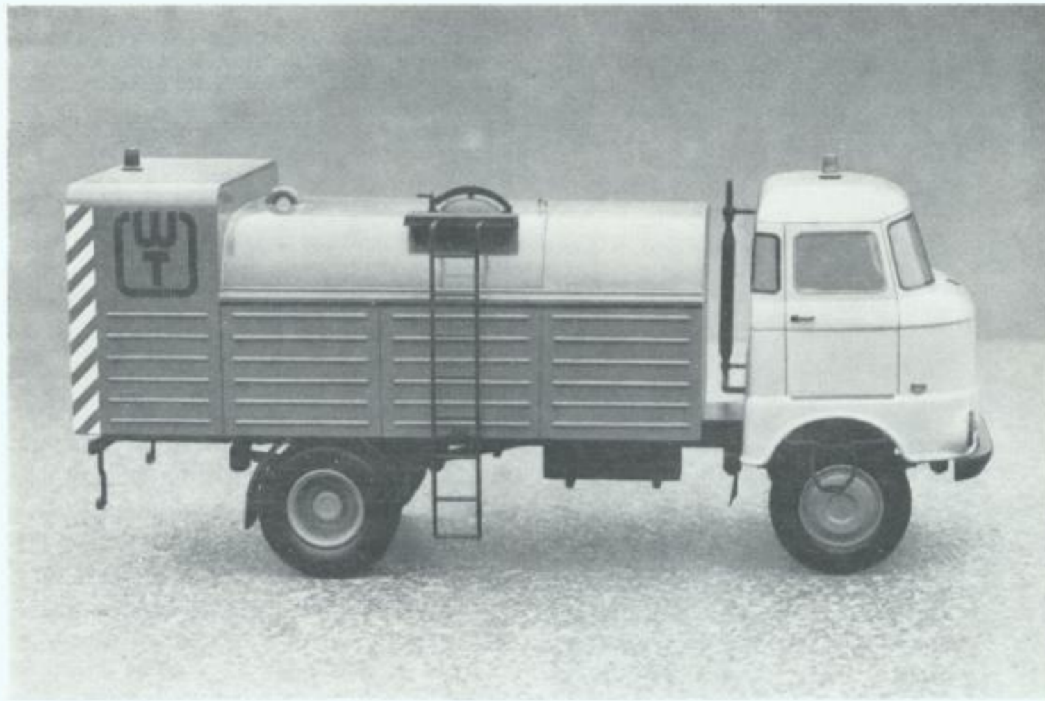
6 Hochdruckspülergerät, Aufbau auf Basis des Lkw-Typs W 50, 1979 Hersteller: VEB Wassertechnik Berlin, 1980 Das Gerät dient zur Reinigung der nichtbegehbaren Kanalisation mittels im Fahrzeug mitgeführten und durch eine Pumpe hochverdichteten Wassers.
