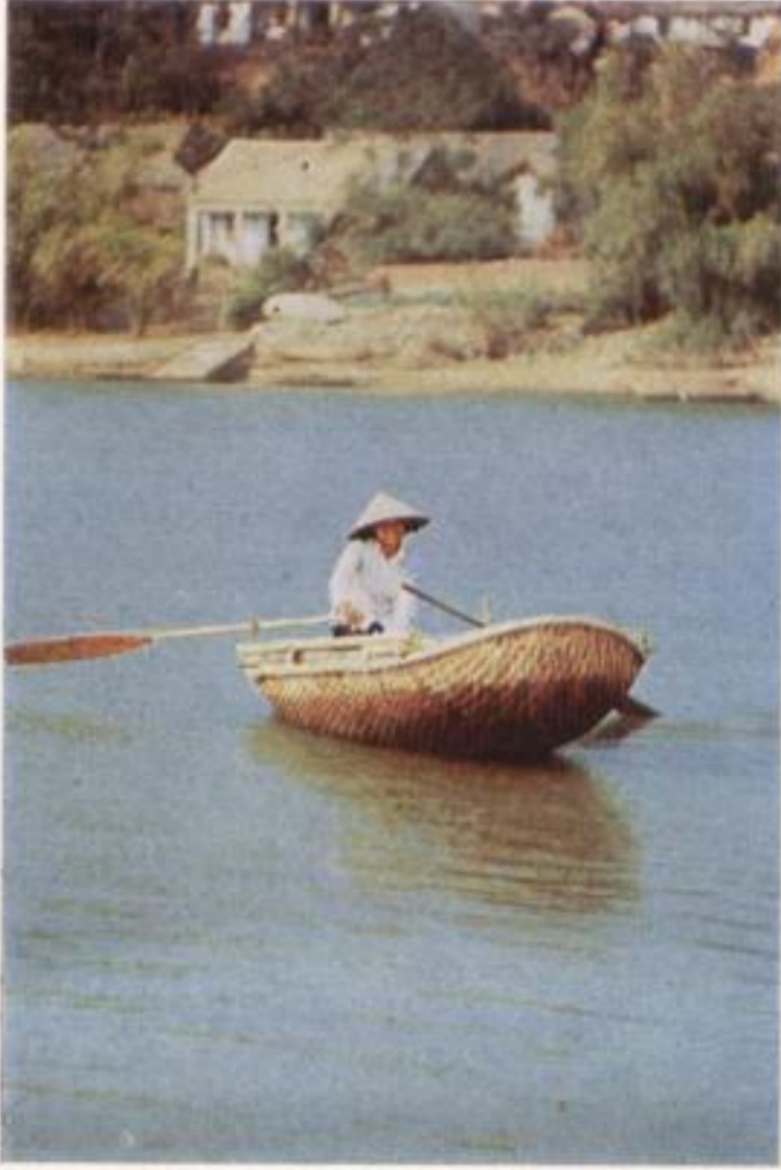
korbartiges leichtes Boot aus geflochtenem Bambus, mit Teer verdichtet Solche Boote können bis zu zehn Personen aufnehmen.
