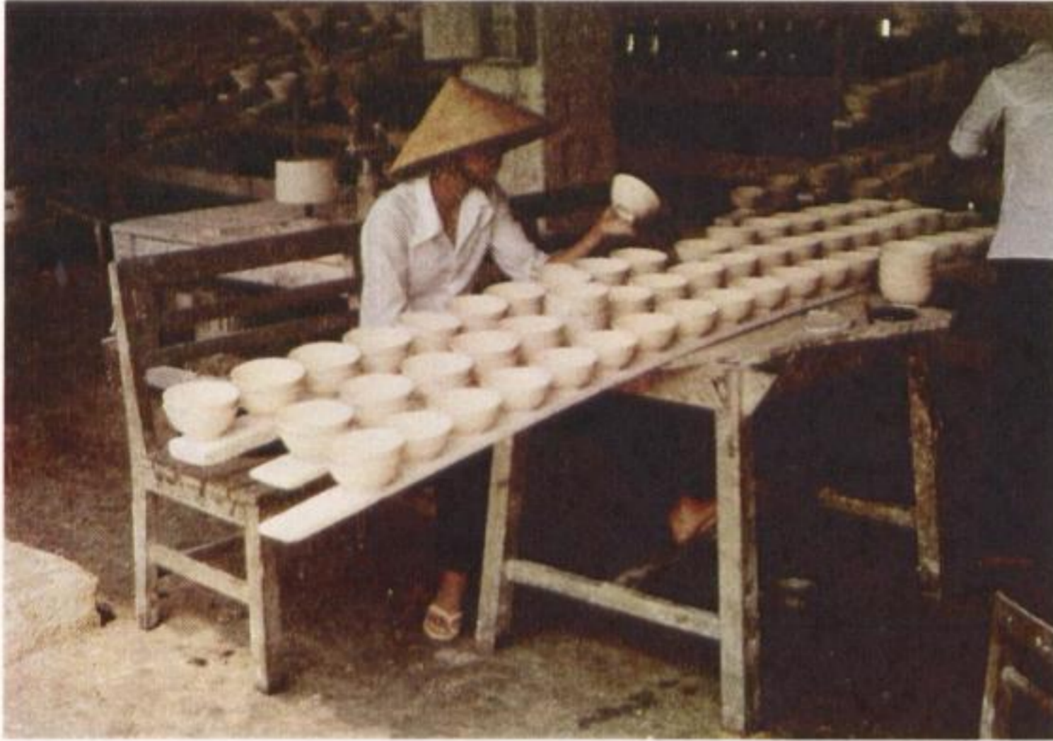
Die Ofenanlage ist tunnelartig an den Hang gebaut und am unteren Teil architektonisch abgegrenzt. Formung und Trocknung der ungebrannten Teile erfolgen in offenen Gebäuden.
