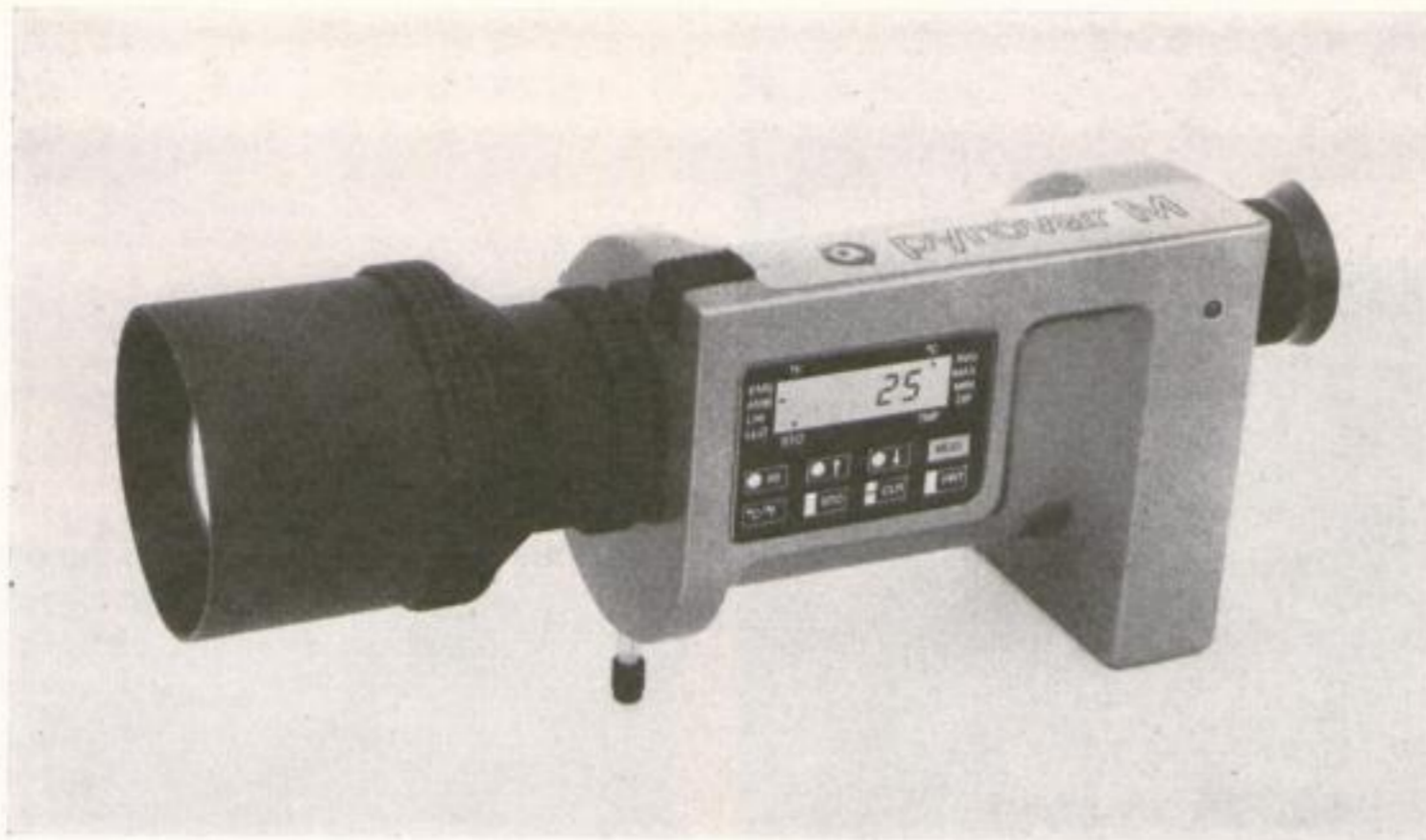
Handpyrometer mit Mikrorechner Gestalter: Hartmut Putz, 1987/88 Ergonomie: Frank Puscholt Auftraggeber und Hersteller: VEB Meßgerätekombinat „Erich Weinert“ Magdeburg, Betrieb des Kombinat VEB Elektro-Apparate-Werke Berlin-Treptow „Friedrich Ebert“
