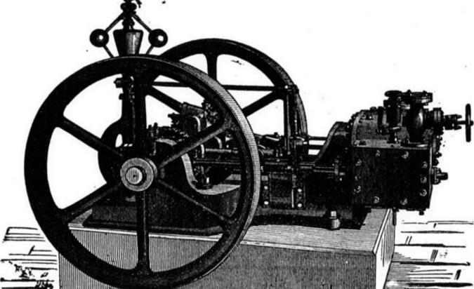
werden von mir seit 6 Jahren in Stärken von 10 bis 300 Pferden mit oder ohne Kondensation als Spezialität gebaut. Dieselben eignen sich besonders für solche Anlagen, bei denen es auf Kohlenersparniß oder regelmäßigen Gang (elektrische Beleuchtung) ankommt.
