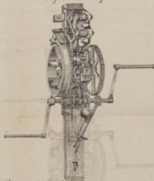
Stilmant'sche Bremse Fig. 6 als Hand Hebel Bremse 1/10 nat. Größe
