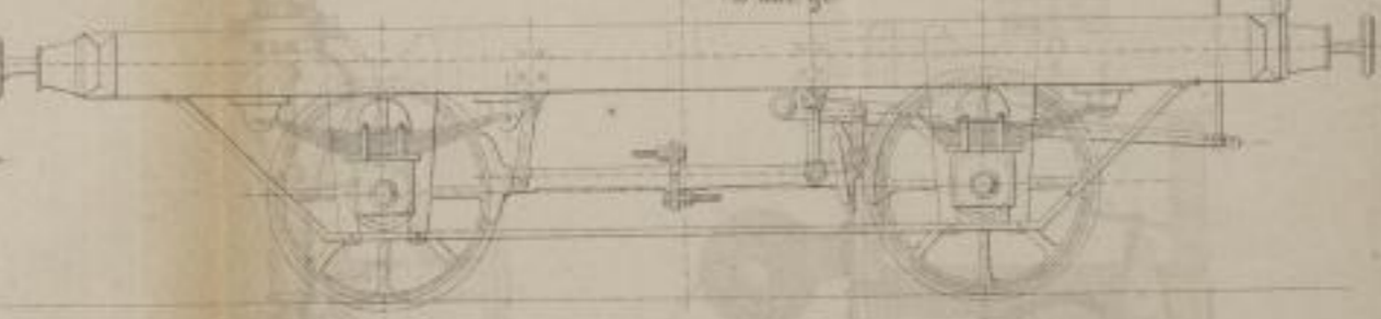
Stilmant'sche Bremse Fig. 7 als Hand Kurbel Bremse 1/10 nat. Größe
