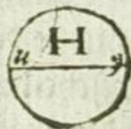
Widerumb es werde dir gegeben ein runde Flächin D. deren diameter a e, welche vmb 6. mal ist zuverjüngern. Nimm den diameter a e. vnd setze ihn mit hülff des Handcirkels in linea Geometrica zwischen 6. vnd 6. als dann zeigt die weitte zwischen 1. vnd 1. den diametru des Circels H. so sechs mal kleiner ist als D.
