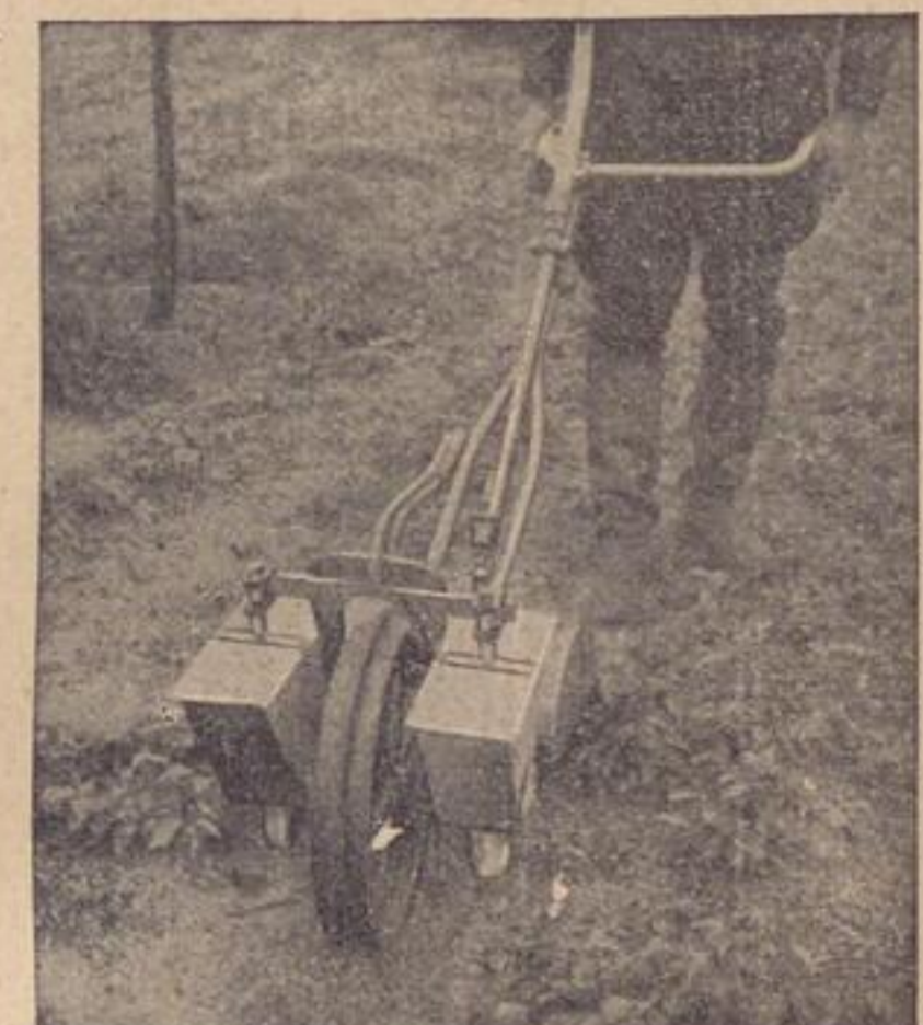
Zweireihiger Düngereisen, bei Reihenbreiten von 40 cm und mehr verwendbar. Rührwerk-antrieb durch eine Steckverbindung mit der Lauf-radachse. Abb.: Werkphoto (2)
