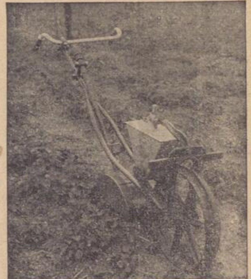
Einreihiger Düngereisen, auch in schmalsten Kulturen verwendbar. Das Rührwerk wird durch eine Kette vom Laufrad angetrieben.
