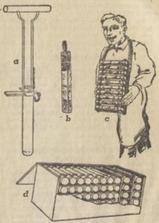
Abb. 1: a) Oberflächensauger. b) Einsatz für den Bohrer. c) Gestell zum leichteren Befördern der Einsatzhüllen vom Feld. d) Versandkasten für die Einsatzhüllen zum Abtransport zur Bodenuntersuchungsstation.
