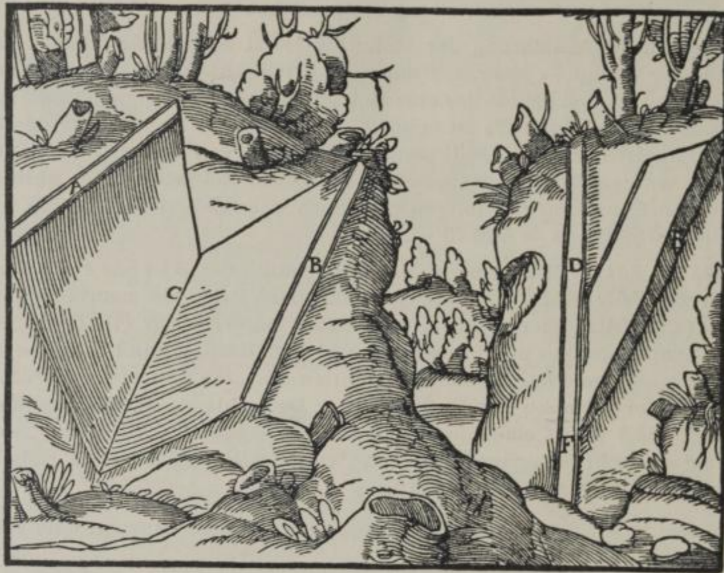
Zwei Gänge, die beide schräg einander zufallen A, B. Die Vereinigung beider Gänge C. Ein senkrecht einfallender Gang D. Ein schräg einfallender Gang, der dem senkrecht einfallenden zufällt E. Die Vereinigung beider Gänge F.
