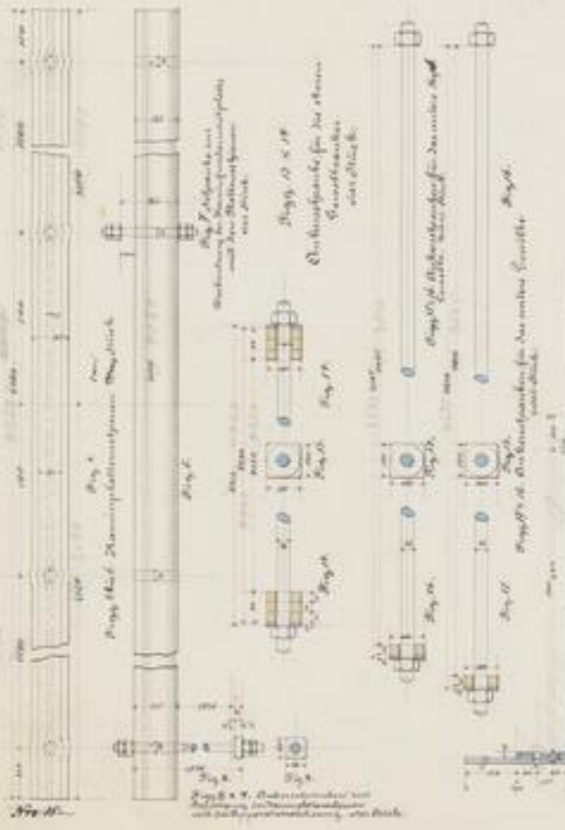
Fig. 21 bis 23. Details für die Holzverankerung des Rostes.
