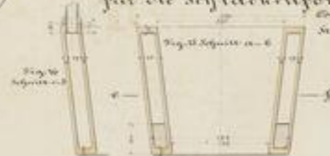
Fig. 13. 14. Mapelle für die Schlackenform. Kont. No. 438 Stück. 8
