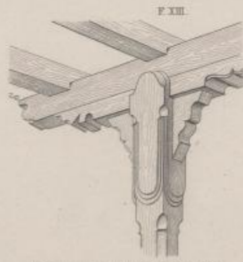
Stütze mit Unterzug und Sattelholz (Unterseen, Anfang 17 ter Jahrh.)
